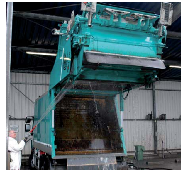
De milieuwagens worden met hoge druk schoongespoten maar door de montage van dieptefiltratie krijgt vocht geen kans in het hydraulische systeem
