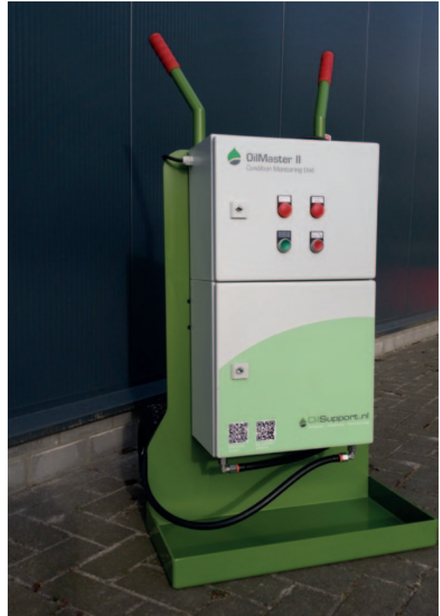
De mobiele LubeMaster 2 wordt ingezet bij ondermeer calamiteiten zoals slangbreuk en pompfalen of preventief bij verdenkingen.
