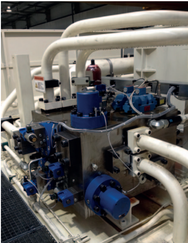
De cartridgekleppen in dit moderne kleppenblok zijn gevoeliger voor vervuilde olie dan de oude kleppen. Monitoring en een goede filtratie zijn hier dus nog belangrijker.
