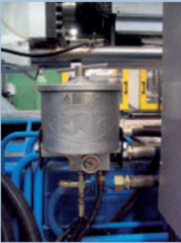
De BU100 oliereiniger op de spuitgietmachine.
