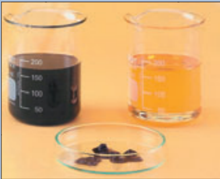
Olie, voor (links) en na (rechts) reiniging.
